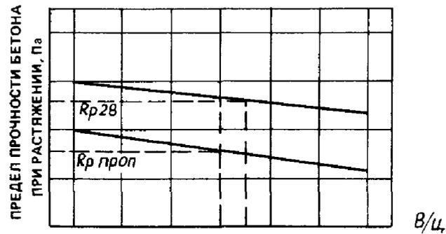
Рис График зависимости Ц П и прочности бетона на растяжение  $R_{p проп}$   $R_{p}$  пределы прочности бетона при растяжении после тепловой обработки и в возрасте сут
