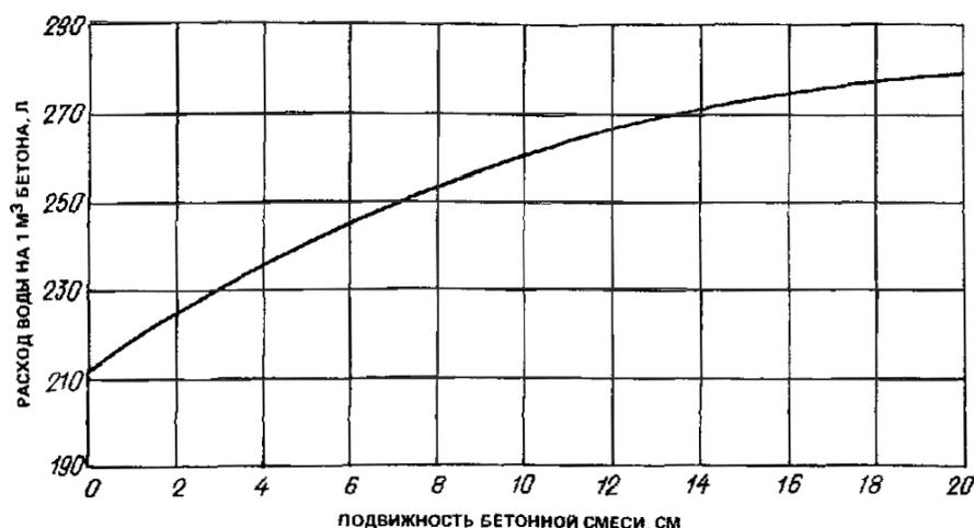
Рис. Зависимость расхода воды на м бетона от подвижности бетонной смеси
