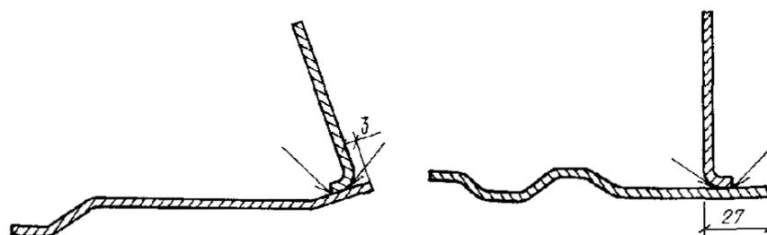
Рис Закладные изделия привариваемые к кольцам для защиты трубопроводов от электрокоррозии
