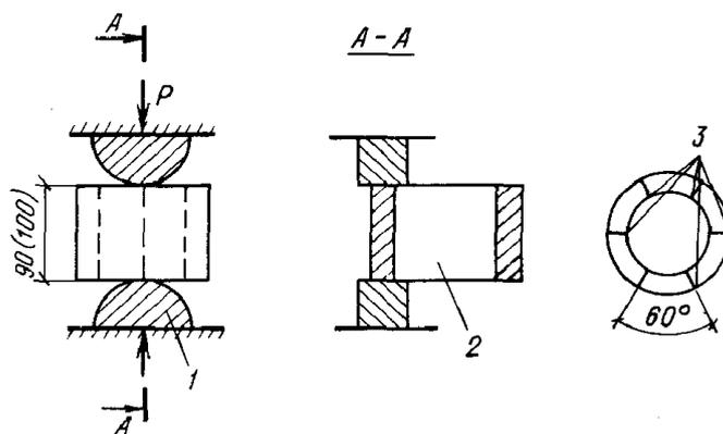
Испытание образцов на растяжение при раскалывании
